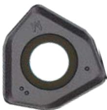
Износостойкий микрозернистый слой Al<sub>2</sub>O<sub>3</sub> и слой связующего TiCN обеспечивают отличную износостойкость при высокоскоростной обработке. Специально разработанный спеченный твердый сплав обеспечивает превосходную устойчивость к излому и термическому растрескиванию, предотвращает внезапное разрушение режущей кромки.
