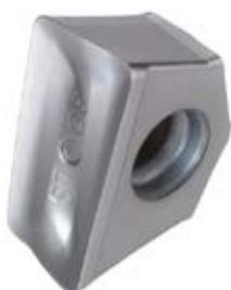
Усовершенствованная ультратонкая спеченная твердосплавная основа отличается повышенной прочностью при сохранении твердости. Многофункциональное покрытие Al-Ti-Cr-N обеспечивает оптимальную устойчивость к высокой температуре и износу. Благодаря сочетанию этих свойств, пластины обладают великолепной стойкостью к образованию трещин и высоким сопротивлением к налипанию из-за очень низкого коэффициента трения при обработке титановых
