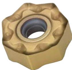
MP7030 имеет многослойное покрытие из недавно разработанного соединения на основе титана. Оно обеспечивает превосходную износостойкость и стойкость к образованию трещин при обработке нержавеющей стали. Специальная прочная спеченная твердосплавная основа обеспечивает превосходную производительность при обработке труднообрабатываемых материалов, таких как нержавеющая сталь.
