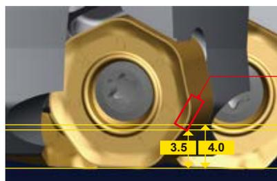
Радиус при вершине пластины с противоположной стороны
